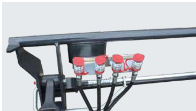
3.º e 4.º Função Para o fácil funcionamento dos acessórios hidráulicos, como pinças de silagem, forquilhas de fardos ou empilhadores de fardos.
